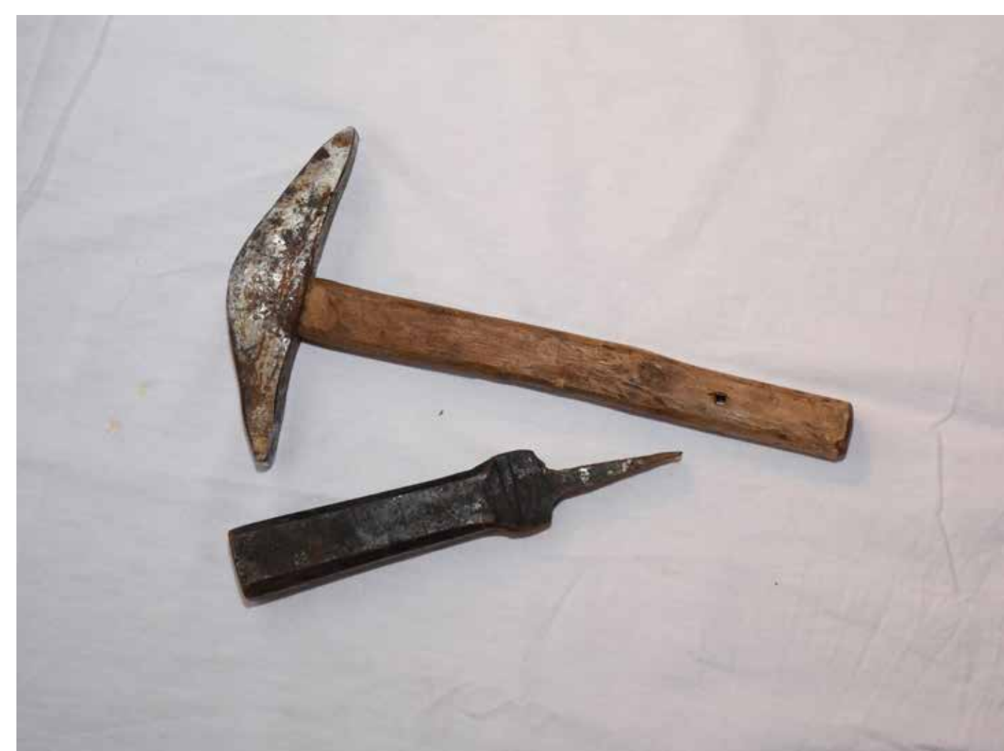
Der spezielle Dangelhammer mit dem Dangelstock.
