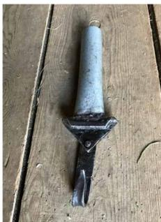
Der Ölhaken wird zum schmieren des Seils benutzt.
