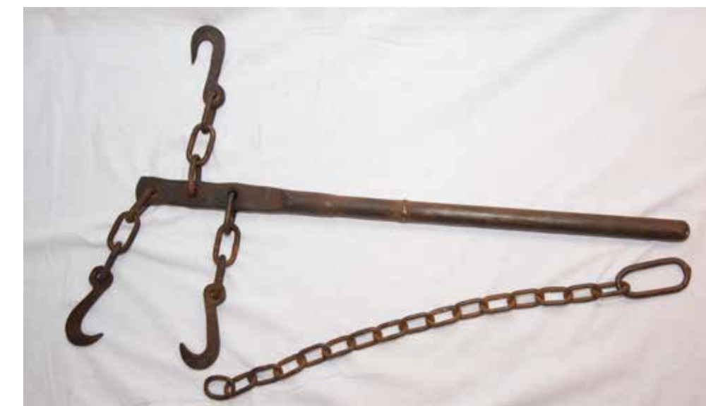
Mit dem Waldteufel werden Seile gespannt.
