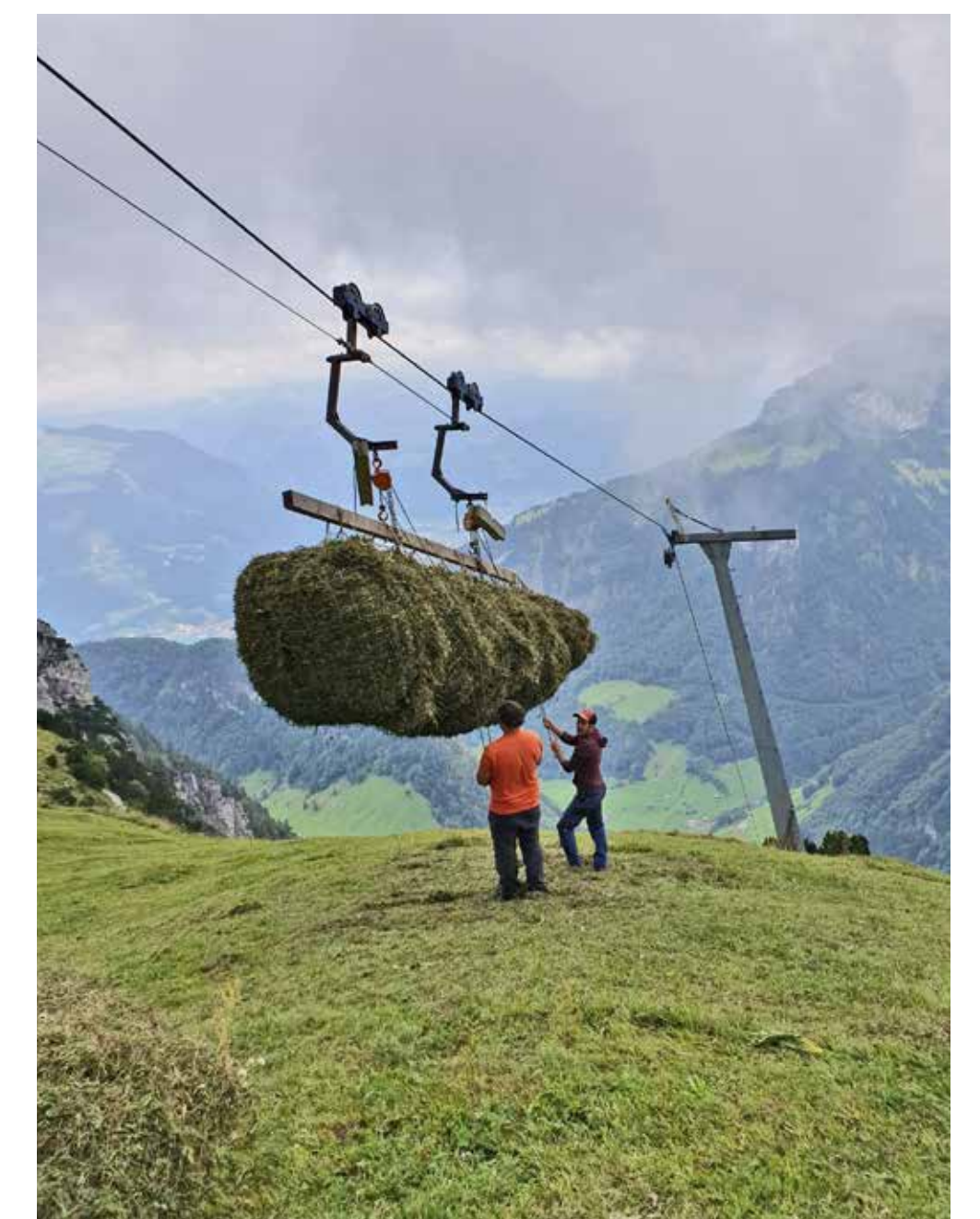
Heutransport vom Bärkli im Usser Baberg zur Sonnenhalbstrasse Stalden. An der absenkenden «Laufkatze» können bis zu 10 Pinggel aufgezo-gen und ins Tal geseilt werden.
